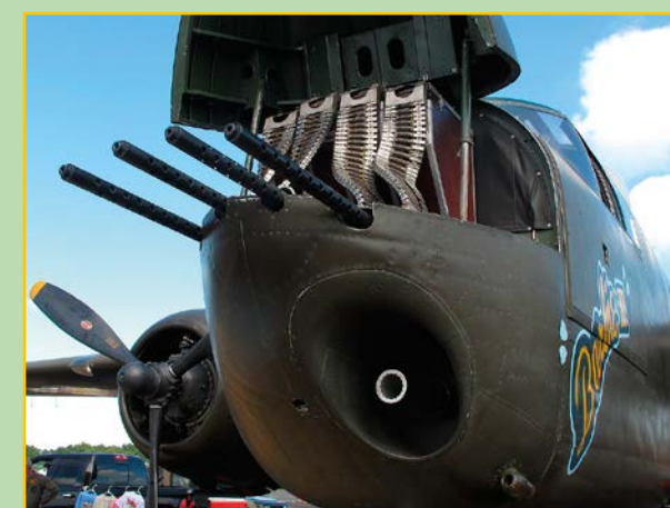
L'armamento in caccia del B-25 G Mitchell constava di un cannone M4 da 75 mm e di 4 M2 .50.
