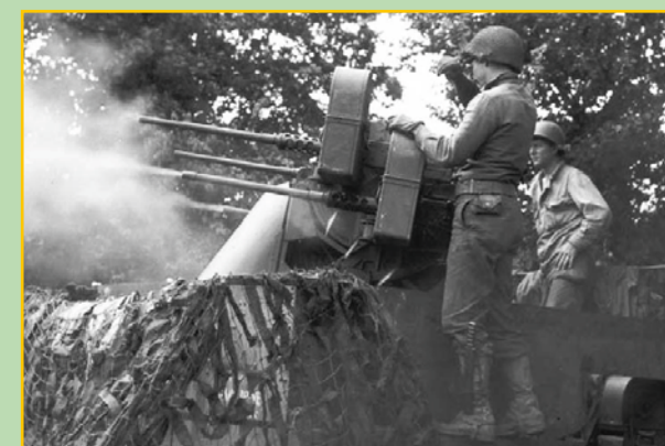
La Maxson M-45 era dotata di quattro M2. Il movimento, elettrico, dipendeva da un generatore.
