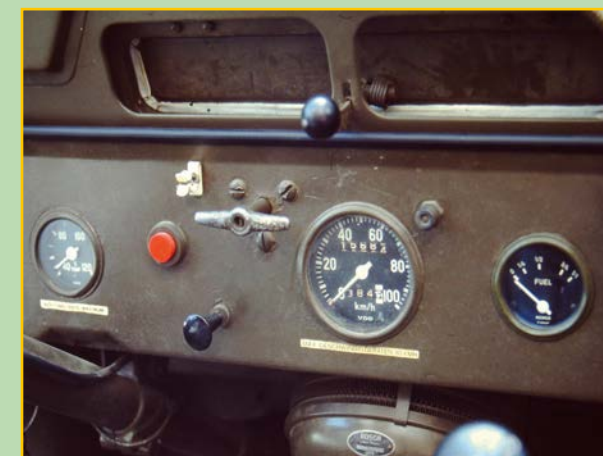
Ridotta la strumentazione: termometro dell'acqua, tachimetro e indicatore livello carburante.
