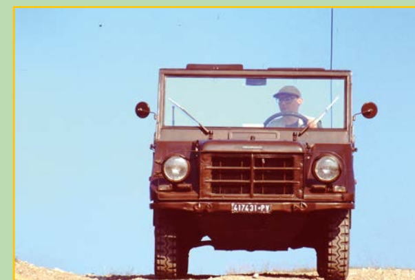
L'ampia calandra assicurava il flusso d'aria necessario a raffreddare il motore a due tempi.
