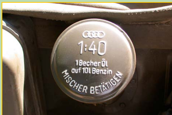
Le Munga dell'esercito tedesco erano equipaggiate di un miscelatore manuale nel serbatoio.
