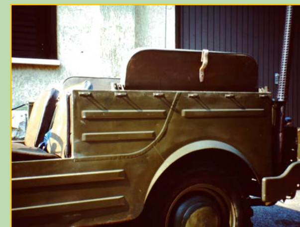
Per trasformare in camionetta l'originaria carrozzeria torpedo erano montate apposite sezioni.
