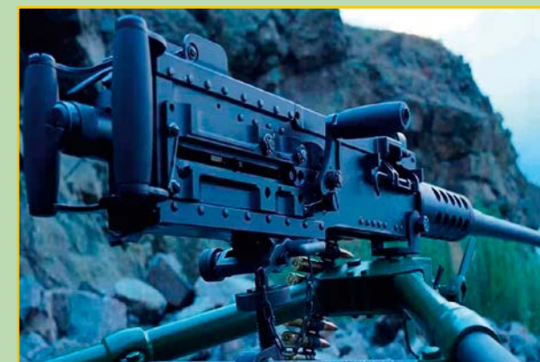
Ben evidenti in questa inquadratura la doppia impugnatura (in legno) e la "farfalla" di sparo.
