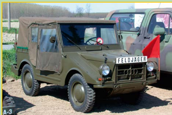
La capote a mantice si ripiega velocemente, le porte si ripongono piegate dietro alla fiancata.
