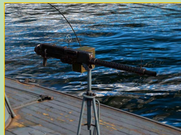
La Breda realizzò per le Forze Armate italiane una variante della M2, in calibro 12,7x81 (la M2 è 12,7x99).
