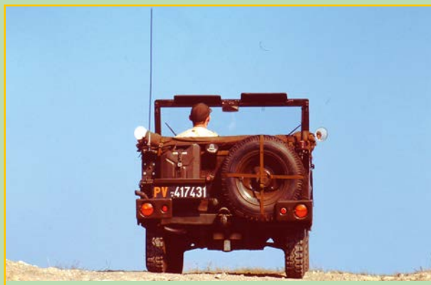
La croce sul differenziale posteriore, illuminata, serviva per la marcia notturna in colonna.
