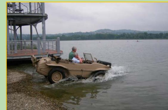
Nella Volkswagen Typ 166 l'elica nella marcia su strada è fissata al cofano motore con due cinghie di cuoio. Una volta in acqua, viene abbassata in posizione d'uso mediante un'apposita lunga bacchetta.
