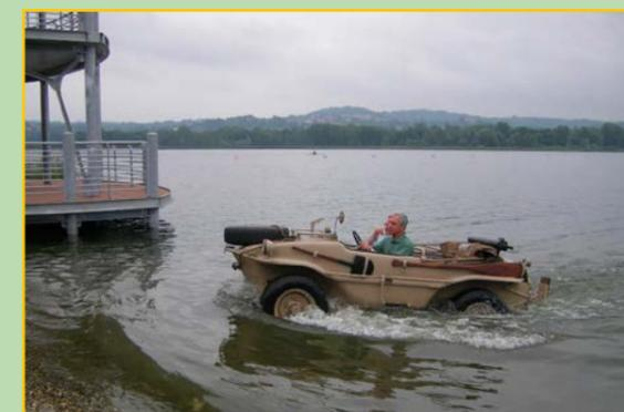
Per la Typ 166 erano previsti pneumatici specifici di larga sezione con disegno studiato per aumentare il grip nella marcia fuoristrada, anche se talvolta venivano montate le stesse gomme della Kübelwagen.
