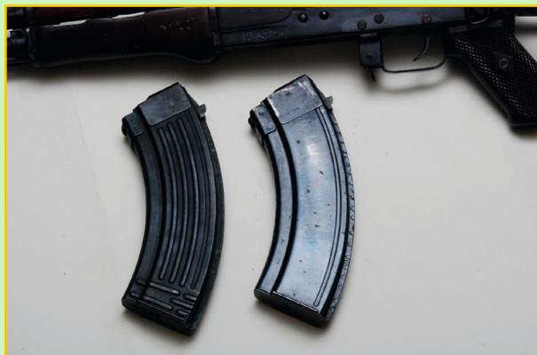
Pur essendo perfettamente compatibili, i serbatoio dell'AKM (a sinistra) presentano vistose differenze rispetto a quelli dell'AK-47.
