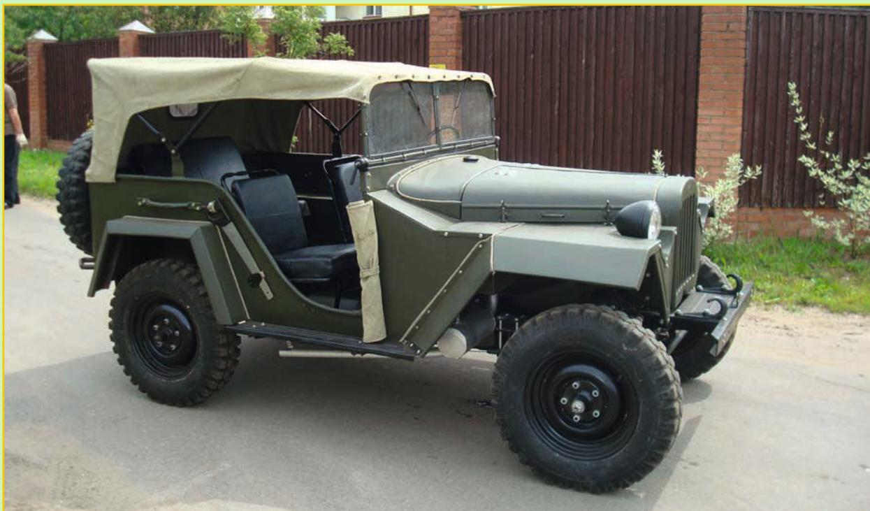
L'allargamento della carreggiata per le GAZ 67 e 67B rese necessaria la modifica della carrozzeria, con l'introduzione delle rustiche appendici spioventi dei parafranghi.
