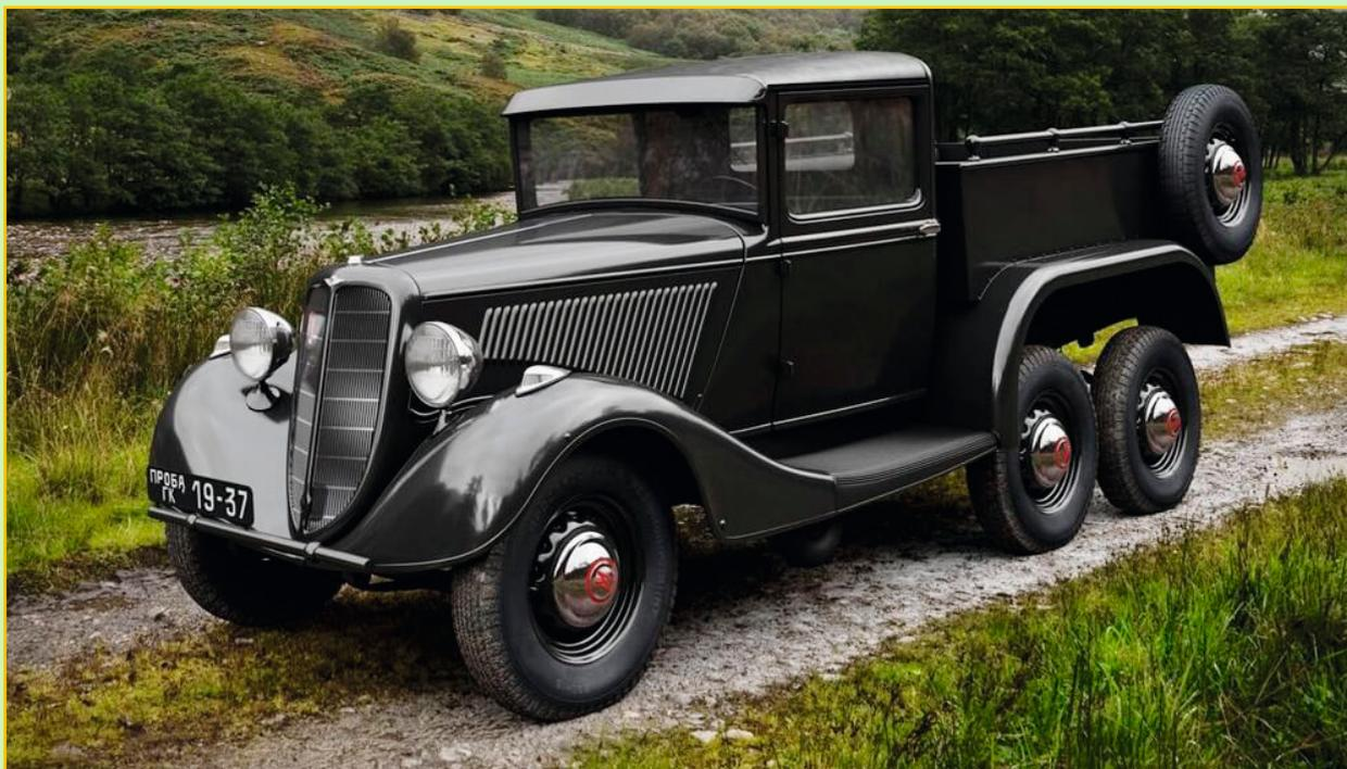
La GAZ 21 fu la prima vettura sviluppata in URSS nell'ottica di realizzare un veicolo leggero in grado di muoversi su strada e fuoristrada. Era una 6x4 che utilizzava componenti Ford.
