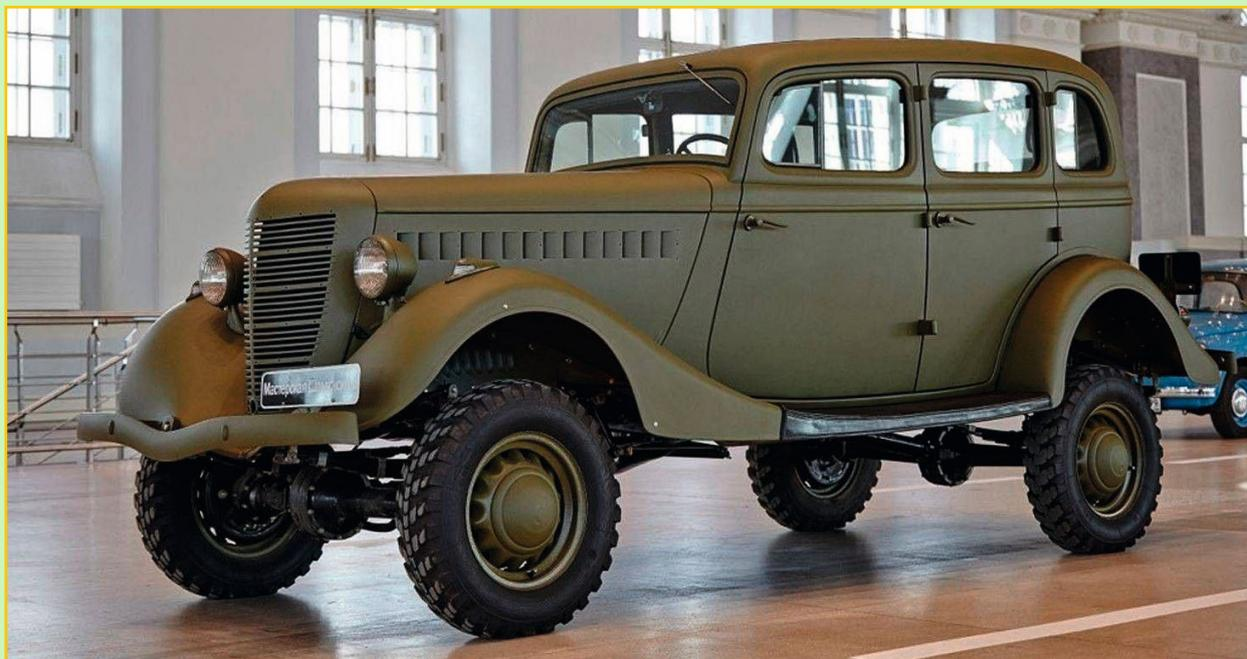
L'autotelaio GAZ 61 poteva essere equipaggiato con carrozzerie diverse: berlina (61-73, sopra) pick-up con abitacolo chiuso (61-415) o pick-up con abitacolo scoperto (61-417).
