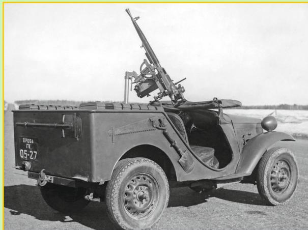
Utilizzando componenti meccanici GAZ (Ford) e adattando parti della famiglia 61 Grachev diede origine alla GAZ 64, per poter servire nell'Armata Rossa come veicolo multiuso, automezzo per collegamento, ricognizione, trasporto ufficiali e per il traino del cannone controcarro da 45 mm M1937 (53-K). L'ufficio progetti della GAZ, del quale Vi-
