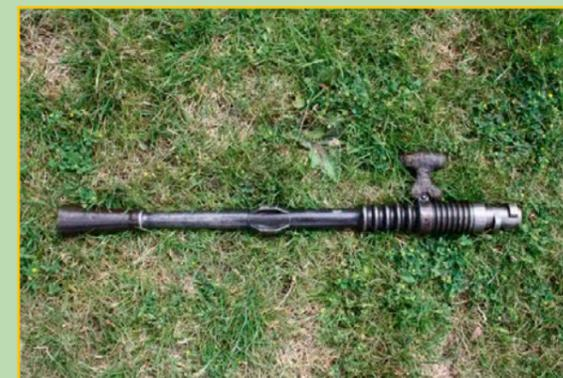
Grazie a un sistema di sgancio rapido, la canna si poteva sostituire in 8-10 secondi. L'impugnatura di manovra era rivestita di un nastro atermico d'amianto.
