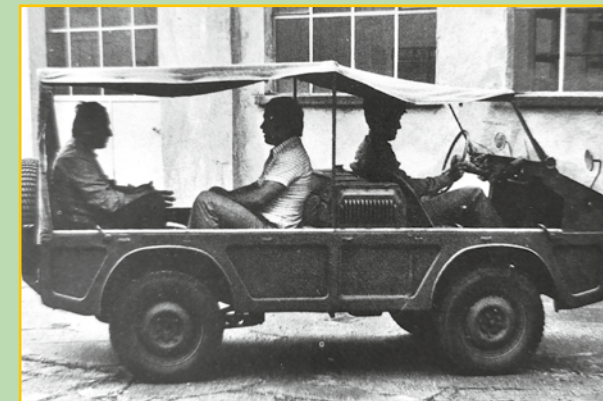
La Camionetta 06, aveva posto di guida avanzato e abitabilità per sei persone (o due persone e 460 kg di carico). Il motore, trasversale, era montato al centro.
