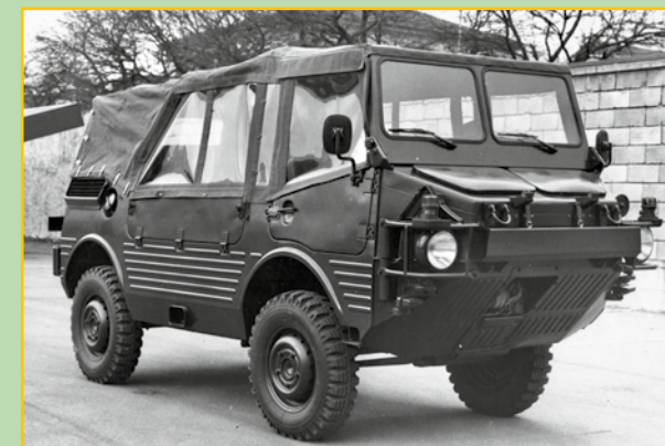
Il VCL 0,5 t, anfibio e aviolanciabile, si andava a collocare idealmente sopra al VSF e avrebbe svolto i compiti di veicolo per ricognizione e collegamento.
