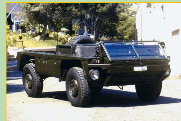
Con il parabrezza ribaltato, l'altezza massima del VSF risultava inferiore al metro. Con una lunghezza complessiva di 3,175 m, aveva un vano di carico di 1,6 m².
