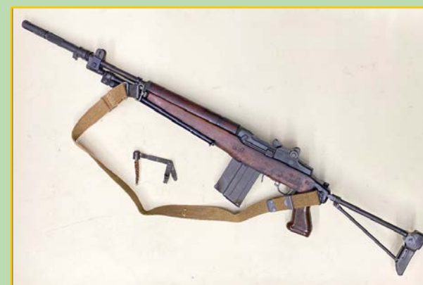
Esteticamente il BM59 Pc (Paracadutisti, sopra) non è facile da riconoscere dal BM59 TA (Truppe Alpine): soltanto la foggia del tricomensatore è un pò diversa.
