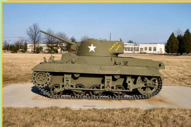
Caratteristiche modello M22 Locust: lunghezza 3,94 mt., larghezza 2,16 mt., altezza 1,85 mt., peso 7,4 ton., motore Lycoming O-435T 6 cilindri contrapposti benzina con 165 hp, velocità 64 Km/h., armamento un cannone da 37mm. ed una mitragliatrice Browning da 7,62 mm.
