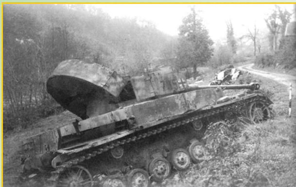
solo contro armi di calibro inferiore ai 20 mm.. Il Mk IV era costruito in acciaio al cromo-molibdeno di alta qualità. Due paratie interne separavano i tre compartimenti del mezzo: la parte del conducente, la camera di combattimento e il motore. La trasmissione era installata tra i sedili del conducente e l'operatore radio/mitragliatore. Il carburante era contenuto in tre serbatoi di 400 litri ciascuno.
