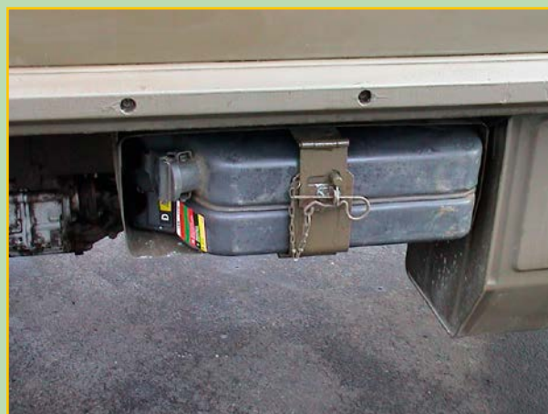
La tanica e la ruota di scorta, nonché la pala di servizio, trovavano posto nella zona sotto la carrozzeria.
