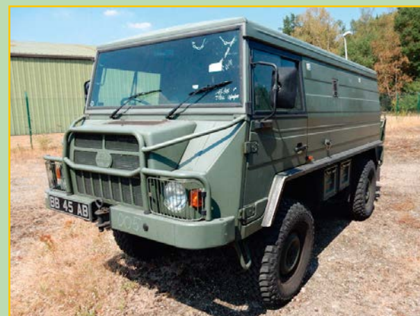
L'ultima variante di produzione, costruita in Inghilterra, si riconosce da quella austriaca per il muso diverso.
