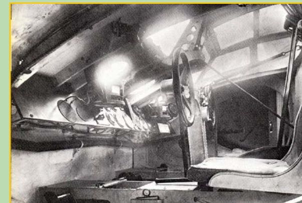
Pilota e co-pilota erano alloggiati proprio sotto all'incastellatura dei motori. L'abitacolo, come quelli di tutti gli aerei dell'epoca, era oltremodo spartano.
