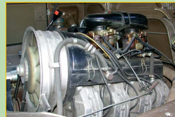
Il motore di 2,5 litri raffreddato ad aria forzata era installato inclinato, con le testate sulla destra dello chassis.
