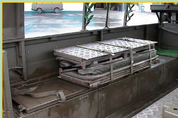
Sulle versioni M, per trasporto di personale e materiale, le panchette posteriori potevano essere ripiegate in molti modi.
