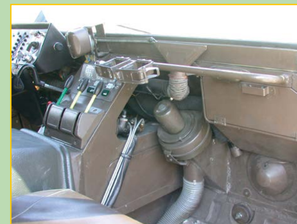
Al centro della plancia erano previste tre leve colorate per l'innesto trazione e il bloccaggio dei due differenziali.
