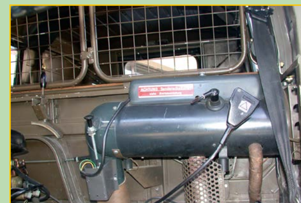
Nell'allestimento K, la versione veicolo comando-mezzo radio, l'abitacolo era dotato anche di riscaldatore.
